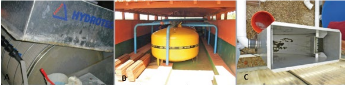
Figura 5 - Filtros mecánicos: a) tambor giratorio (Filtro de tambor); b) filtro de arena similar al que se usa en las piscinas; c) filtro de pantalla fija.
