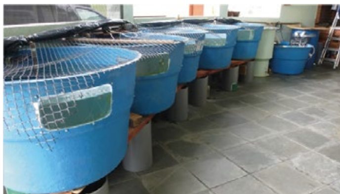
Figura 1 - Sistema RAS pequeño para la producción de peces ornamentales. Estructura con cinco tanques de cultivo, decantador de sólidos de fondo cónico, filtro biológico por escorrentía y reservorio de retorno de agua donde se realiza la aireación y calentamiento del agua.
